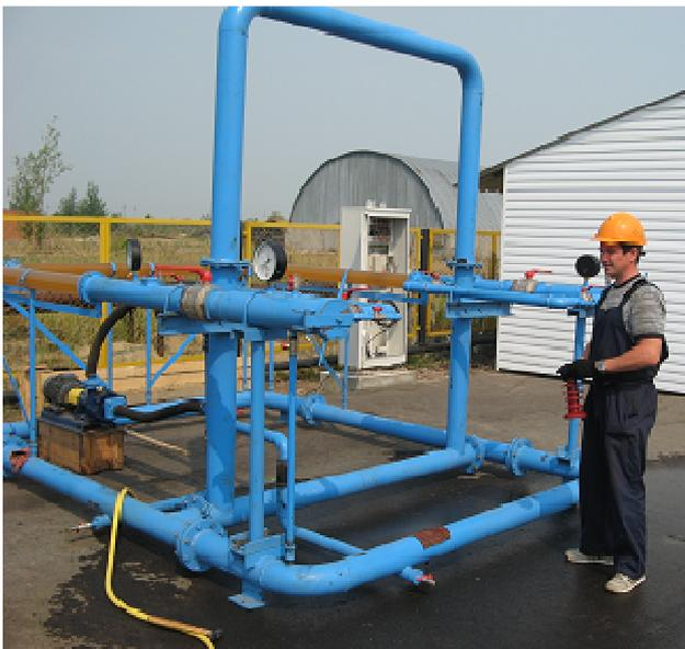
Автоматизированная обучающая система по запуску и приёму очистных устройств (гидростенд с прозрачными трубами Ду-100)
