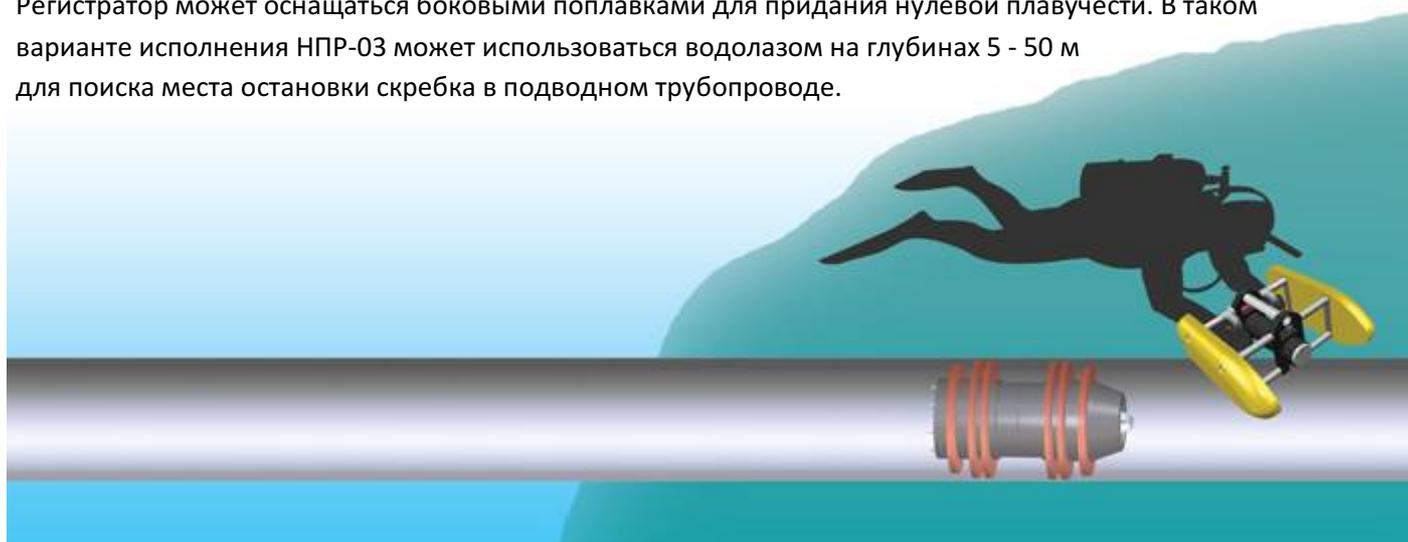
Прочный корпус НПР-03 позволяет применять его на глубинах до 3000 м при внешних давлениях до 30 МПа.
