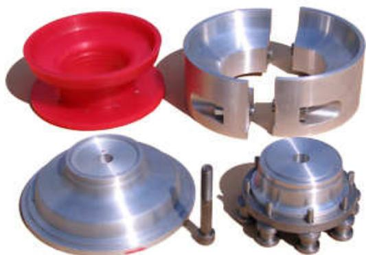
Полиуретановая манжета диаметром 150мм и заливочная форма для её изготовления
