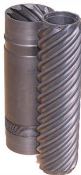
Статор и ротор из копролона для винтового многозаходного двигателя (длина 300мм, диаметр 70мм)
