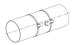
РПС-00 предназначен для контроля движения очистных скребков и других внутритрубных объектов при проведении очистных и диагностических работ на трубопроводе.
